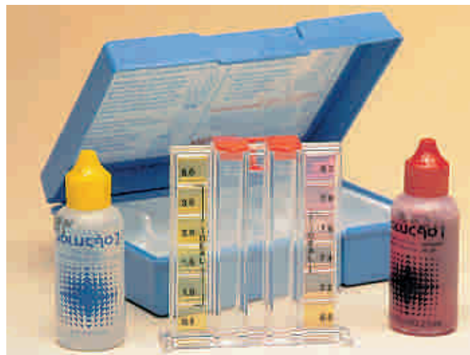
Kit utilizado para medir o pH e a concentração de cloro em piscinas.
