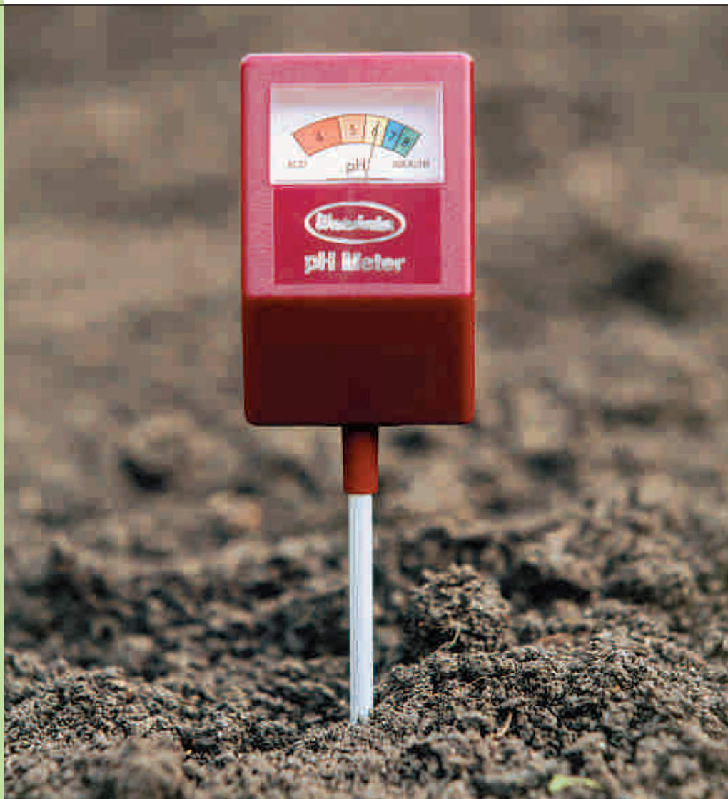
Peagâmetro utilizado para medir a acidez ou a alcalinidade do solo.
