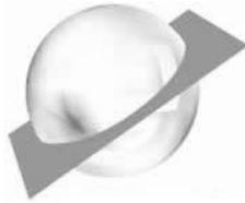
*Espeho esférico* é uma calota esférica na qual uma das superfícies é refletora. Quando a superfície é a interna, o espeho é denominado *côncavo* (ex: espehos de aumento, como dos dentistas, de barbear, etc.) e, quando a superfície refletora é a externa o espeho é *convexo* (retrovisores em motocicletas, em portas de elevadores, fundo de lojas, etc.).
