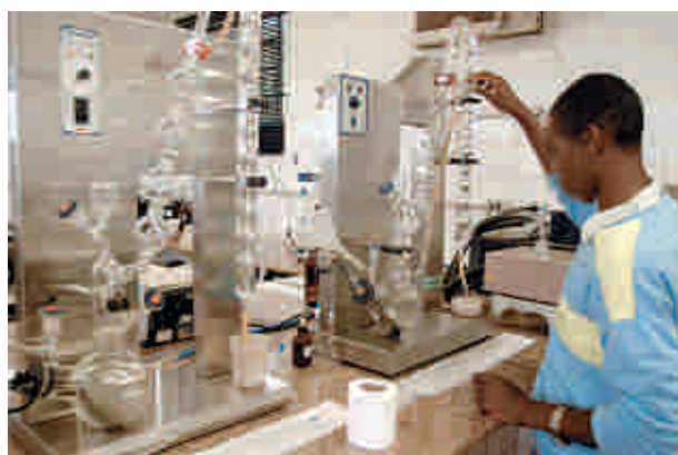
Equipamento de amostragem para controle de qualidade na produção de álcool.
