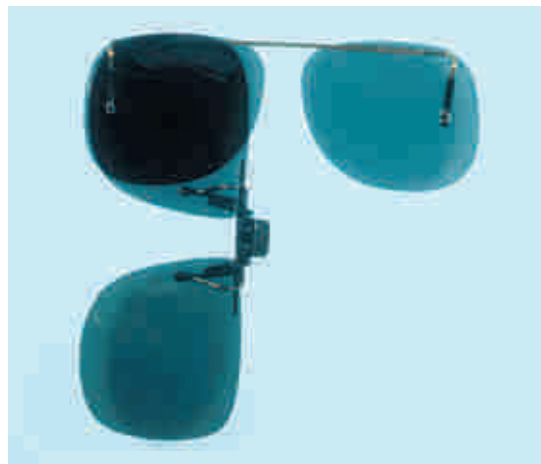
A luz não atravessa dois polaróides colocados perpendicularmente (a 90°).
